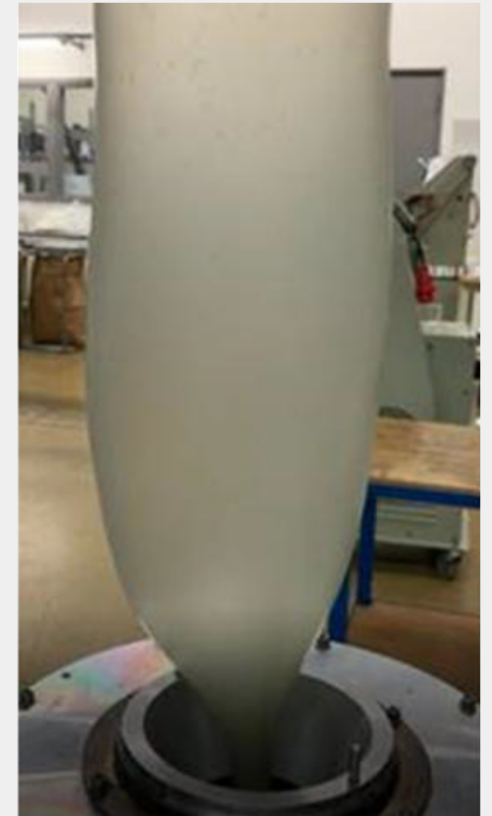
S přidavkem 2,5 % aditiva se struktura r-LDPE obnovila a tavenina získala zpět svou pevnost, což umožnilo proces vyfukování fólie.
